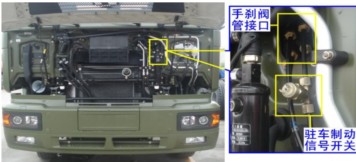
图3 驻车制动信号开关安装于驾驶室前端的情形F2000
