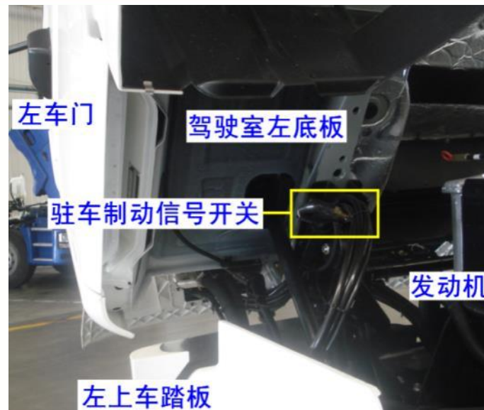
图2 驻车制动信号开关安装于驾驶室左底板下的情形S2000
