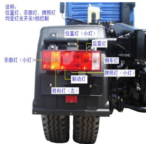
图8 组合后尾灯（左）内各部分示意
