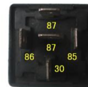
继电器底部的接线端子
