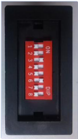
图3：拨码示意图（拨码为36）
